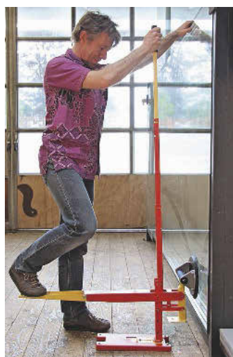
/ Der Fußhebel Pit F kann 200-kg-Lasten mit einer Fußbewegung umstellen.
